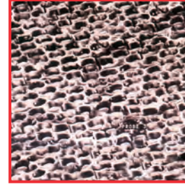
Alüminyum kulp üzerinde materyal saldırısı. Neden: Uygunsuz alkalik temizleyici
