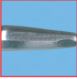
Yetersiz durulama nedeniyle temizlik kalıntıları başka yerlere sürüklenir
