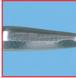
Gözle görülebilir kalıntılara sahip boşluklar
