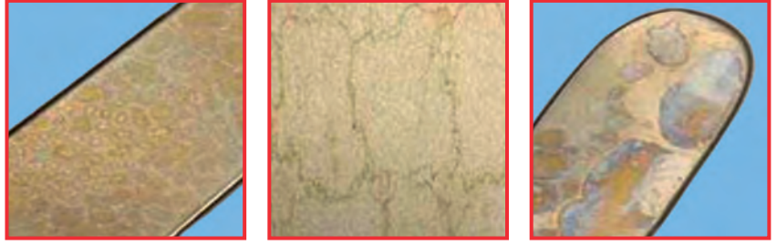
Buharlı sterilizasyon sonrasında tuzdan tamamen arındırılmış sudaki silisik asit içeriğinden dolayı alet yüzeyinde tipik silikat değişimleri görülür.
