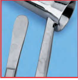
Durulama suyundaki yüksek tuz oranından dolayı leke oluşumları
