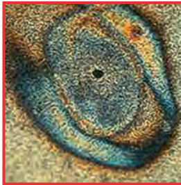
Delik korozyonu örneği
