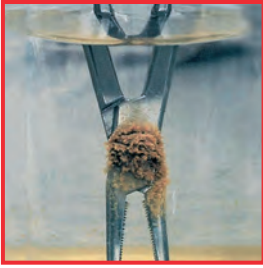
Fizyolojik bir sodyum klorid çözeltisi içine birkaç daldırıldığından dolayı pas oluşumu
