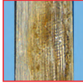
Kemik zımbası, kaydırma parçasındaki kaygan yüzeyde sürtünme sonucu korozyon görülmüştür
