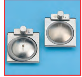
Sağda: Yağla temas ettiği için kabaran contalardan dolayı trokardaki sızıntı yapan kapak valfi. Solda: Yeni kapaklı valf
