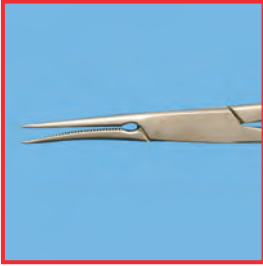
Talimatlara uygunsuz kullanım nedeniyle deformasyon oluşumu
