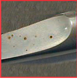
Alet üzerinde kloride bağılı delikli korozyon oluşumu.
