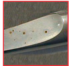
Delik korozyonu örneği
