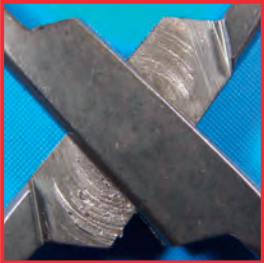
Yetersiz bakım ürünü kullanıldığı için metal aşındırıcılar
