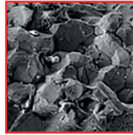
Detay: Tipik paneli, iç kristalin kırık yapısına sahip ağız kırık kıskaç.
