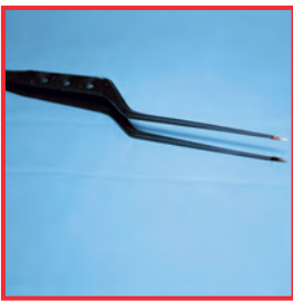
Talimatlara uygunsuz kullanım nedeniyle deformasyon oluşumu
