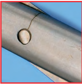
Bir makasın dişli bölgesindeki gerilme çatlakları
