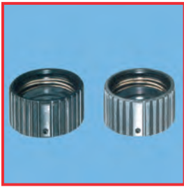
Resmin sağ tarafı: Siyah eloksal sertliği giderilmiş sı tarafından istilaya uğraması.
