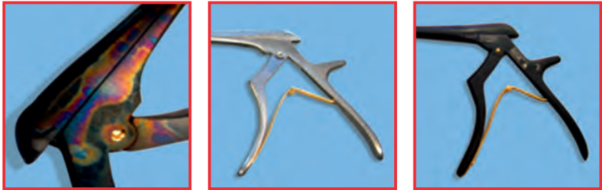
Örnek: siyah, TiAlN kaplı zımba. Renkli parlak boyanmış veya tabaka tamamen kalkmış sağlam altınimsı bileşenler (uç vida, yay).
