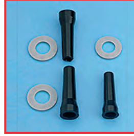
Sağda: Uygunsuz uygulanan alet yapısından dolayı kabarmış contalar. Solda: Yeni contalar
